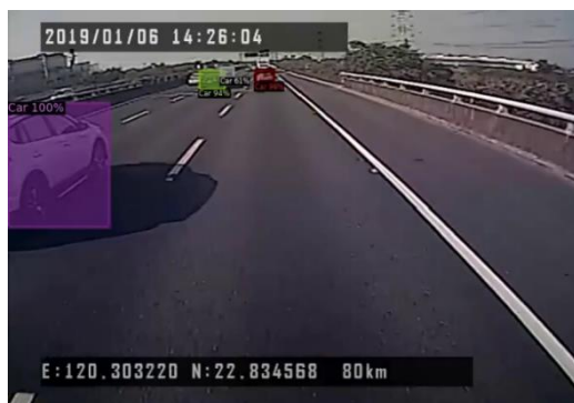
圖 6.3-2 辨識率不佳時輸出值產生跳動結果示意
