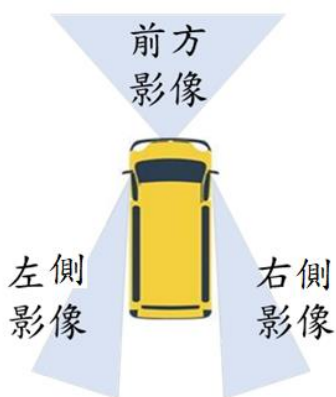
圖 4.3-1 本計畫使用之前方、左側、右側影像示意圖
