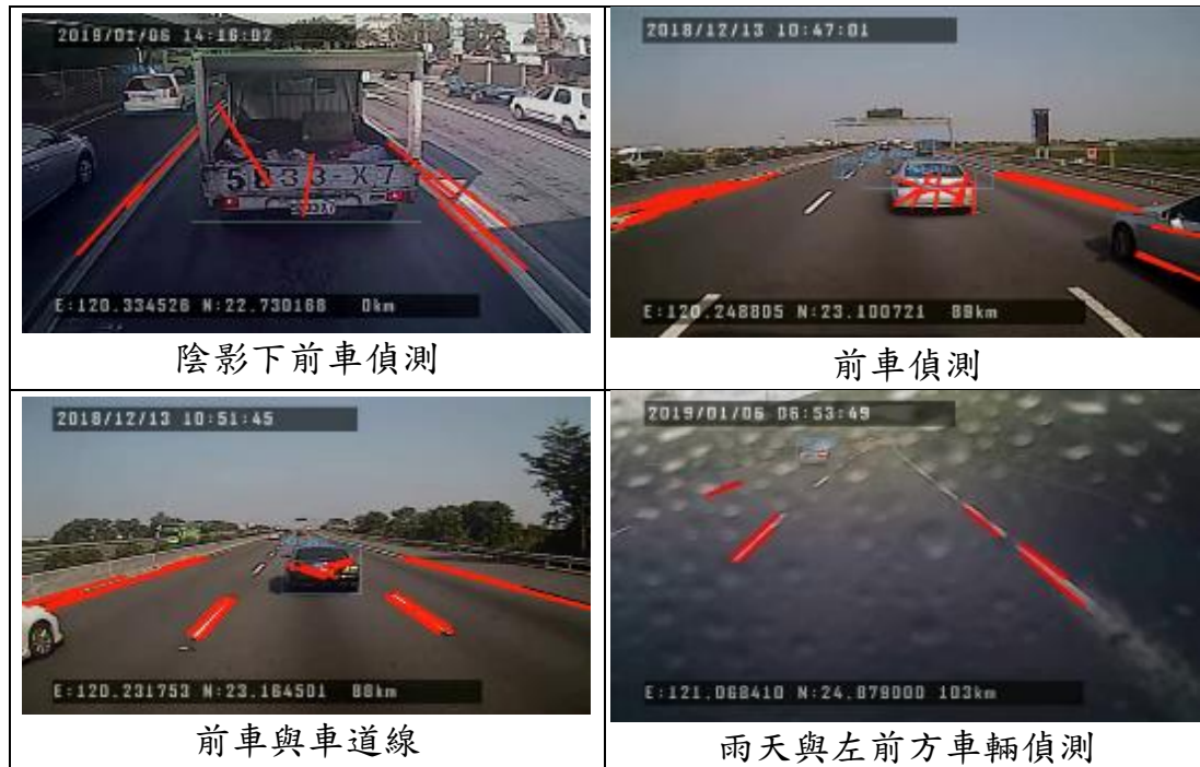
圖 2.3-3 採用影像物件偵測技術辨識車輛與車道線協助光流分類
