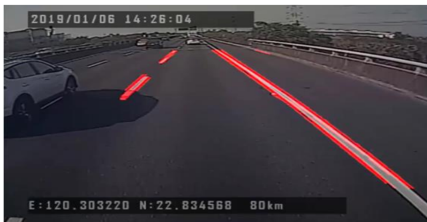
圖 6.2-2 左右車道線之連續延伸辨識結果示意
