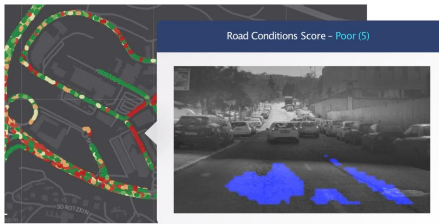
圖 2.4-14 Mobileye 蒐集鋪面狀況資料
