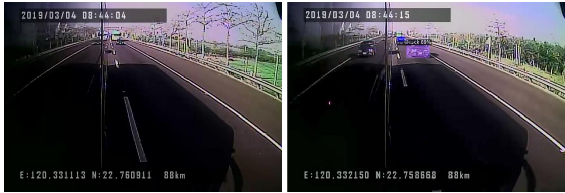
圖 6.3-8 後方鏡頭成像品質明顯影響偵測能力之畫面
